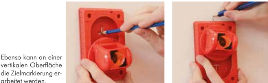
Ebenso kann an einer vertikalen Oberfläche die Zielmarkierung erarbeitet werden.
