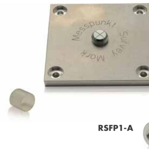
Die Alu-Platte RSFP1 hat ein 5/8"-Edelstahlgewinde zum Aufschrauben eines Prismas oder eines Messinstruments. Wird die Platte als Fixpunkt am Boden verwendet, kann sich der Vermesser mit dem Stativ exakt über dem Kreuz positionieren.
