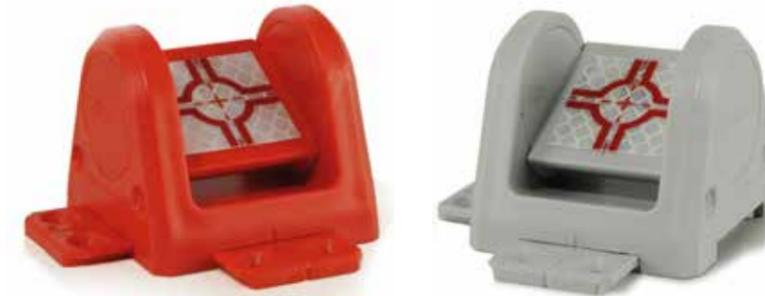
Beim Einsatz von Totalstationen kann die Reflexzielmarke immer genau auf das Messinstrument ausgerichtet werden. Die Reflexzielmarke kann in einem Radius von 180° gekippt werden und ermöglicht die Nutzung des gleichen Vermessungspunktes aus verschiedenen Richtungen. In Verbindung mit unserem Fixpunkt RSFP-X80 kann, durch das Einklicken der Marken in zwei verschiedene Richtungen, der Vermessungspunkt aus fast allen Richtungen angepeilt werden (siehe Bilderreihe links).
