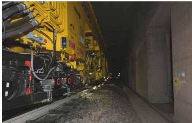
RPM-System installiert auf der 08-275 Unimat Combi (RFI Italia) Gleis-Stopfmaschine
