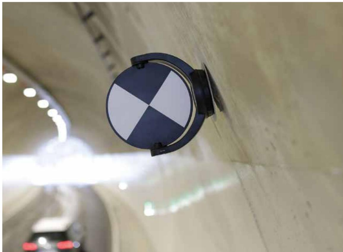
Laserscanner-Marke RSL422M im Tunnel
