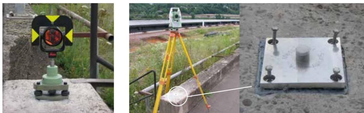
Bei der Verwendung als Fixpunkt auf dem Boden kann dieser Punkt mit einem Prisma eingemessen werden, damit er bei Bedarf, z.B. bei Verdacht auf Versetzung des Fixpunktes durch Fremdeinwirkung, schnell und einfach kontrolliert werden kann.
