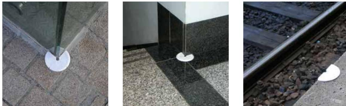
La placa de aluminio RSFP1 tiene una rosca de acero inoxidable 5/8" para enroscar un prisma o un instrumento de medición. Si la placa se utiliza como punto fijo en el suelo, el topógrafo puede posicionarse con exactitud sobre la cruz con el trípode.
