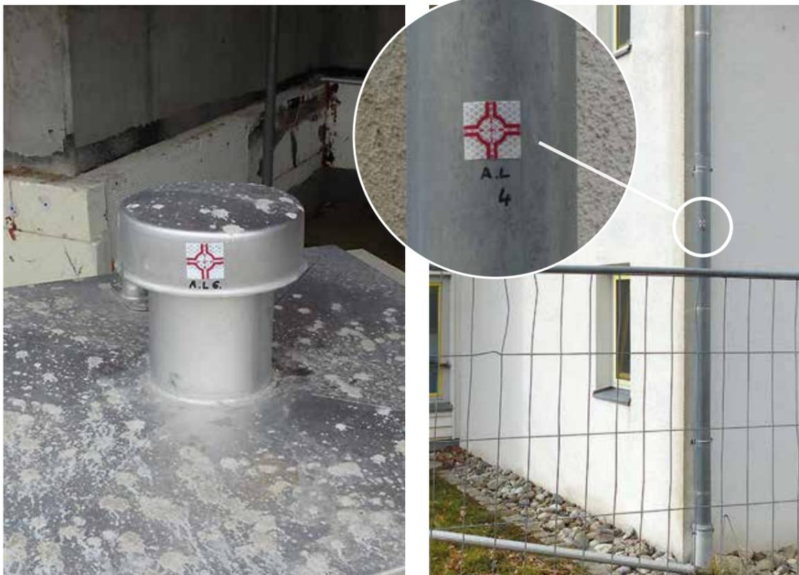
Le grondaie non sono indicate per l'applicazione dei punti di riferimento, poiché risultano essere molto spesso instabili; la forma sferica, caratterizzata da curvature piuttosto strette, influisce inoltre negativamente sulla precisione delle misurazioni.
