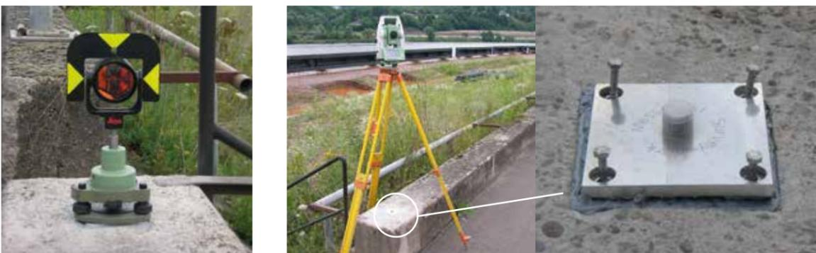
Se il prodotto viene impiegato come punto fisso sul terreno, grazie a un prisma sarà possibile rilevarlo e all'occorrenza sottoporlo a un controllo semplice e rapido, ad esempio nel caso si sospetti il relativo spostamento causato da effetti esterni.
