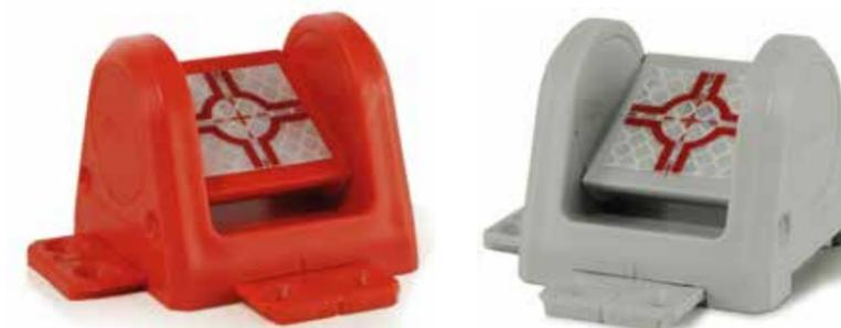
In combinazione con stazioni totali, questo target riflettente assicura un allineamento sempre preciso con lo strumento di misurazione. Il prodotto dispone di una funzione di ribaltamento di 180°, grazie alla quale è possibile usufruire dello stesso punto di misurazione partendo da direzioni diverse. Inoltre, innestando il target nell'RSFP-X80 in una delle due posizioni disponibili il punto di misurazione diventa rilevabile da quasi ogni direzione (vedi la sequenza di immagini a sinistra).
