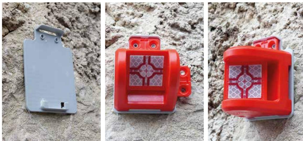
Il target RS183 sul punto di ripresa RSFP-X80g: per un montaggio facile e veloce su qualsiasi superficie. Il semplice innesto del target consente di misurare lo stesso punto sia in orizzontale che in verticale.
