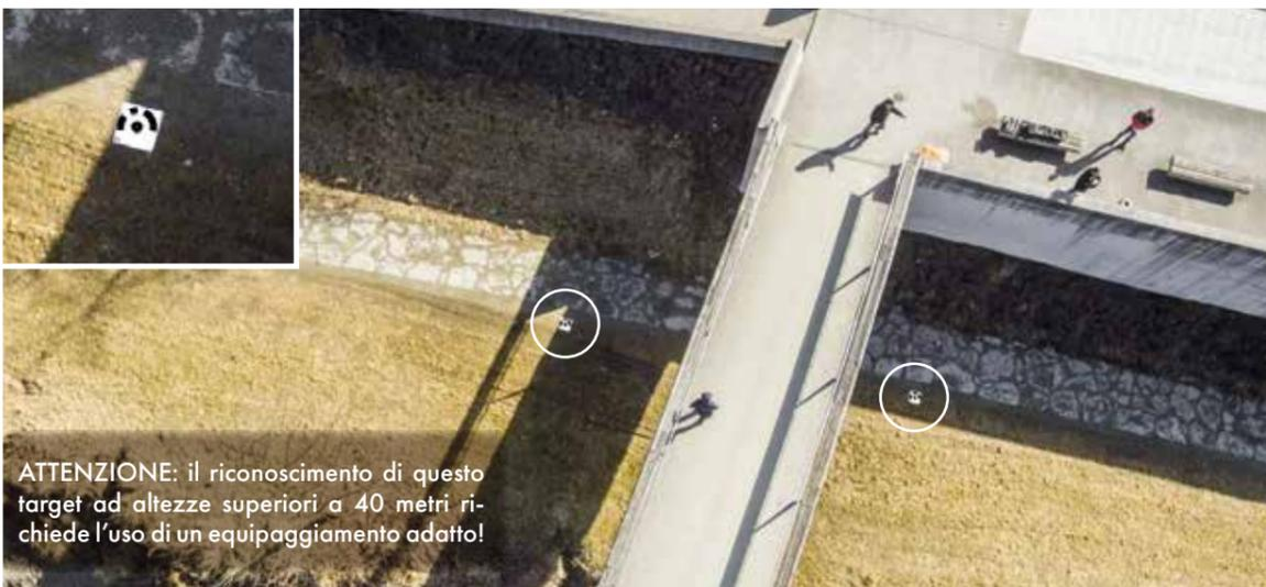
ATTENZIONE: il riconoscimento di questo target ad altezze superiori a 40 metri richiede l'uso di un equipaggiamento adatto!
