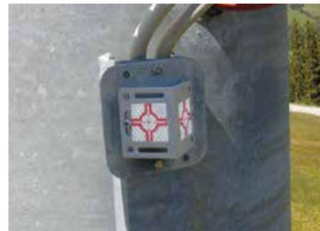
Punto di misurazione sul sostegno di un impianto di risalita
