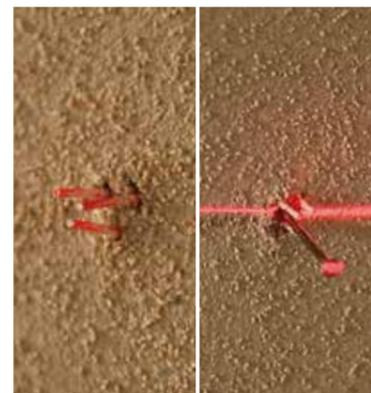
"Pincel de limpieza" elástico para asegurar la línea de nivel hasta después de los trabajos de revoque.
