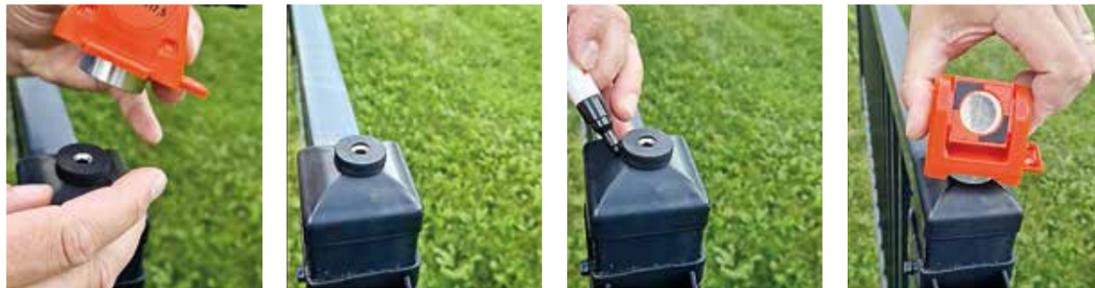
Serie de puntos de referencia con set de imán RSMS-X80: en esta versión, el imán mismo forma el punto de referencia. Los prismas y marcas se pueden girar en todas las direcciones y colocarse y quitarse sin esfuerzo. Después de retirar los prismas o marcas, el imán con el recipiente magnético queda como punto de referencia y puede ser protegido de manera confiable contra la suciedad con la tapa protectora RSPC-X80.
