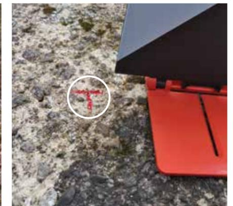
La marcación a través de una ranura en la placa base permite realizar mediciones repetidas.
