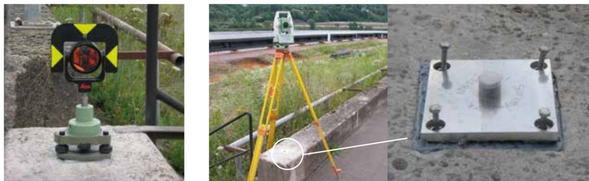
Cuando se utiliza como punto fijo en el suelo, este punto puede medirse con un prisma para poder comprobarlo rápida y fácilmente en caso necesario, por ejemplo, si se sospecha que el punto fijo ha sido desplazado por fuerzas externas.
