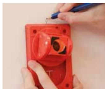
Transferencia rápida de alturas con desplazamiento de altura de 50 mm en la estación total.
