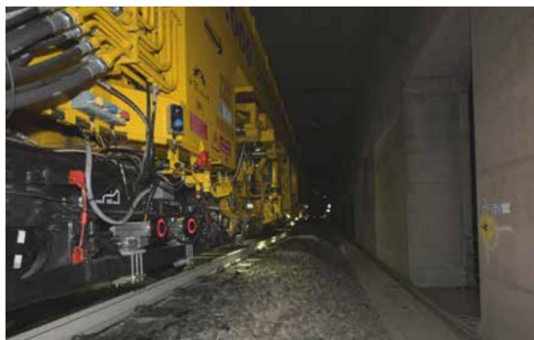
Système RPM installé sur la bourreuse-nivelleuse Unimat Combi 08-275 (RFI Italia)
