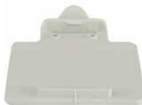
Avec l'adaptateur RSA-X80g-1, il est possible de placer le point de visée du scanner laser précisément sur le point de mesure de RS mini-prisme RSMP380. Le décalage en hauteur s'élève à 60 mm.
