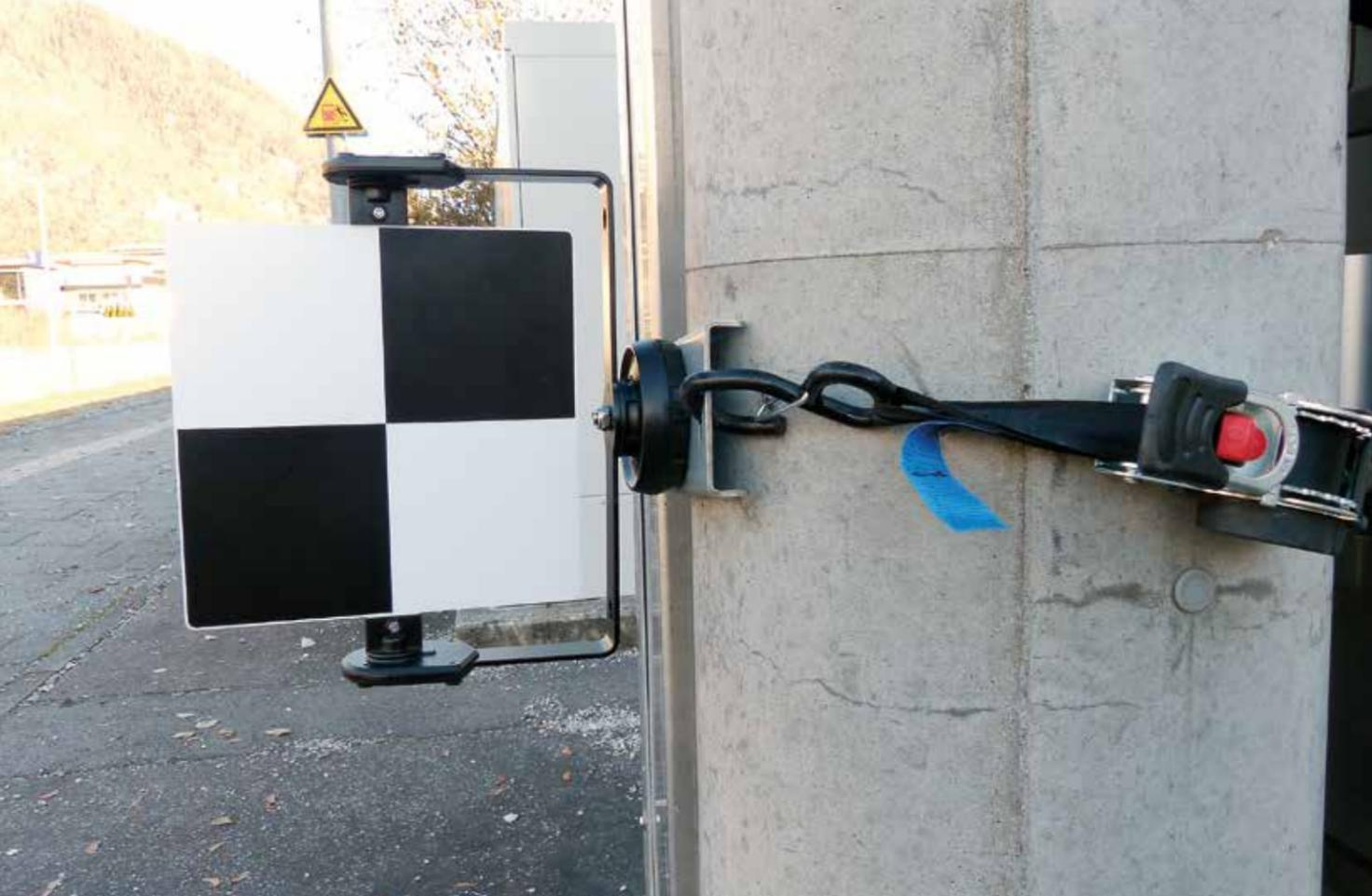
Marque de scanner RSL602M\* sur un pilier en béton : grâce à la solution de sangle RSFP-X99-70, aucun perçage n'est nécessaire.
