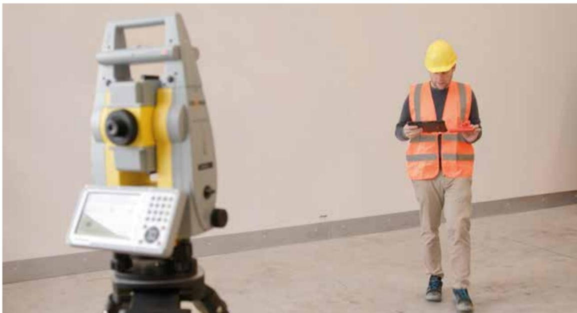
Piquetage à l'aide du système RS150M et de la station totale robotisée
