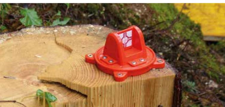
Exemples d'application RS193rM comme point fixe sur différentes surfaces et pour l'alignement exact du chariot de forage.
